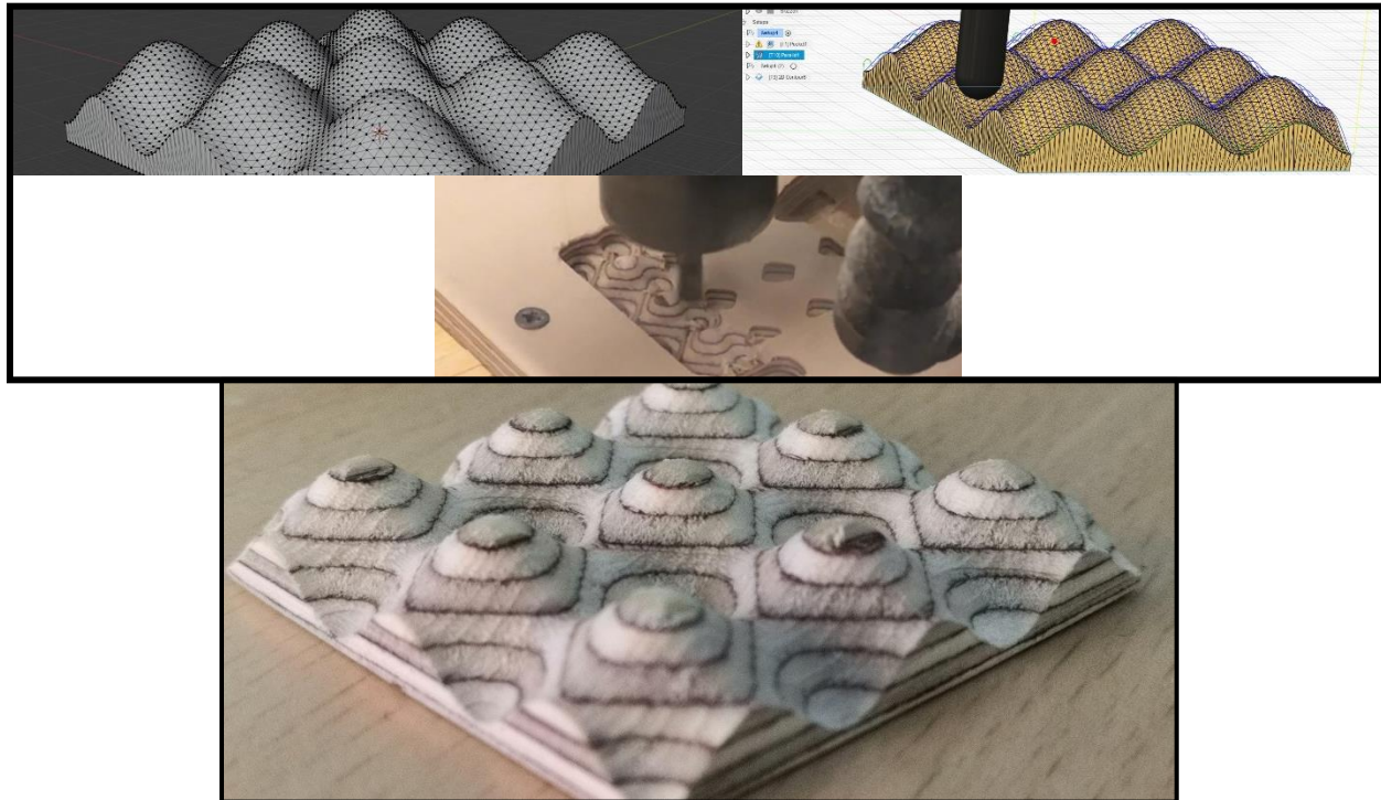
Abbildung 20: von der .stl zum fertig gefrästen Teil
