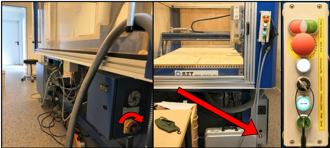
Abbildung 12: Stromschalter, Anschalter und Bedienkonsole der BZT
